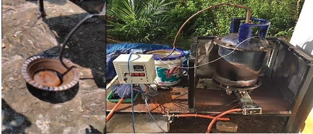
Gambar 2. Rangkaian tabung pirolisator portabel
