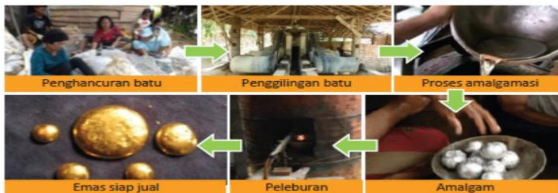
**Gambar 2.** Alur Pemrosesan Emas Pada Tambang Emas Batu keras
