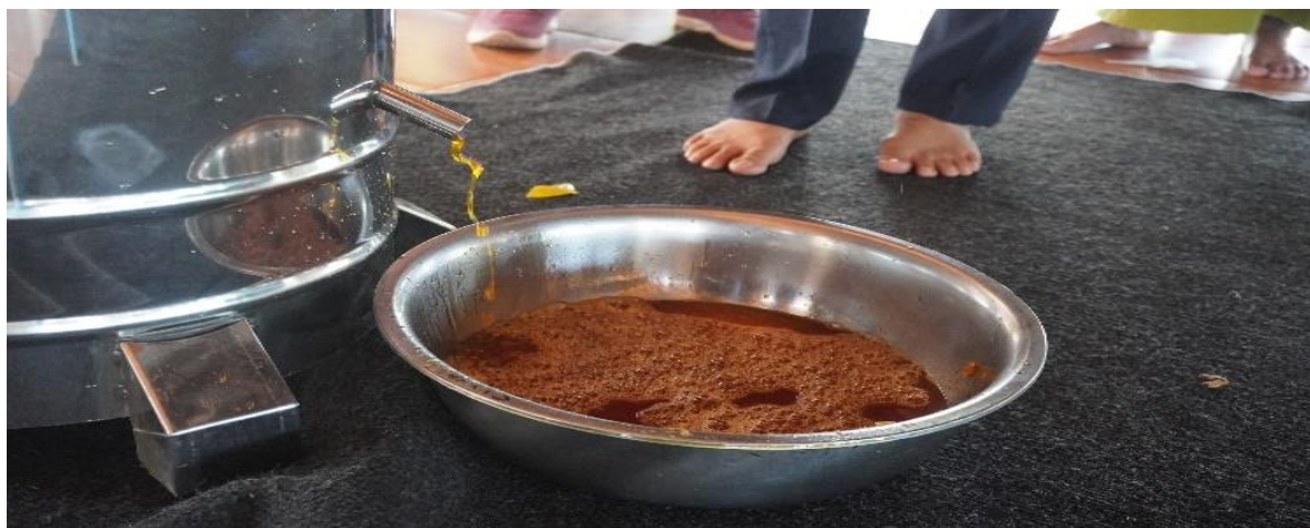
Gambar 7. Proses penirisan minyak oleh mesin spinner
