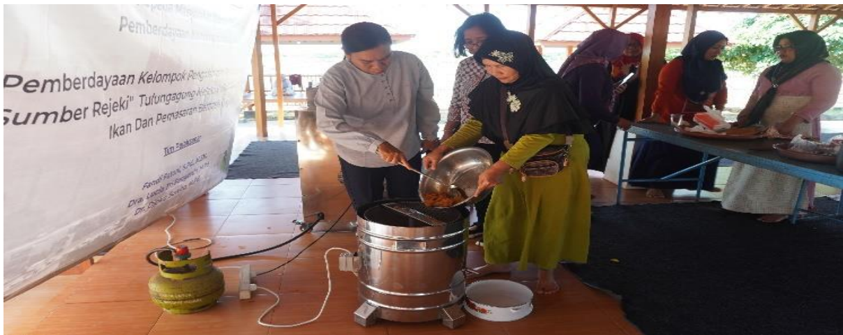
Gambar 6. Pemasukan abon kedalam mesin spinner
