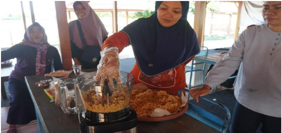
Gambar 2. Penghalusan abon ikan dengan mesin chopper
