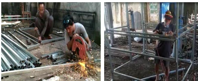
Gambar 3. Proses Pemotongan Besi dan pembuatan rangka container
