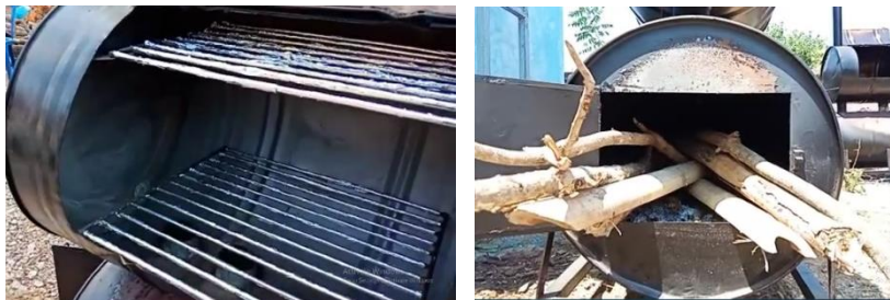
Gambar 2. Bagian Atas (Rak Ikan) dan Bagian Bawah (Pengapian) Alat Pengasapan Ikan
