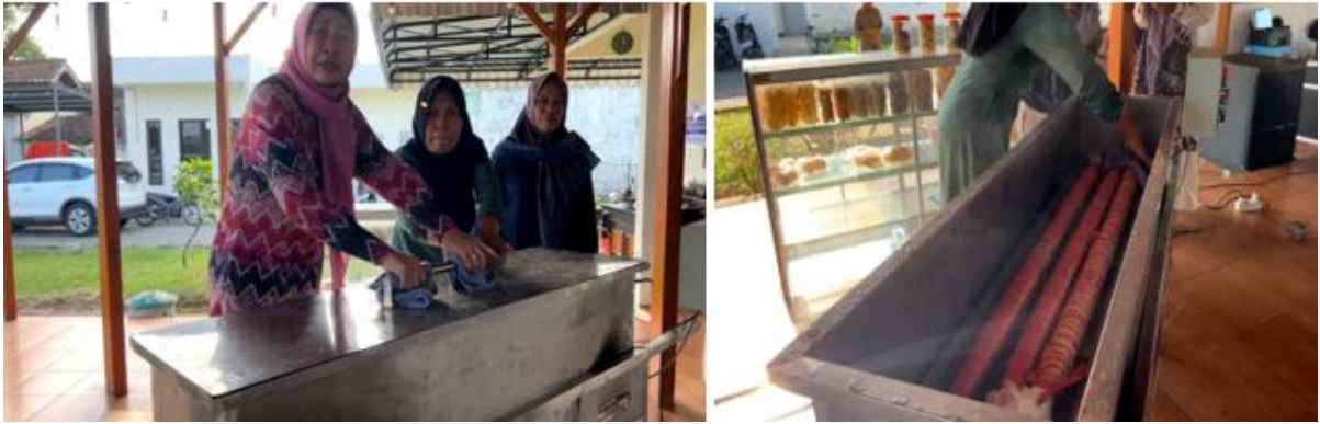
Gambar 6. Proses Perebusan Kain Batik Ecoprint
