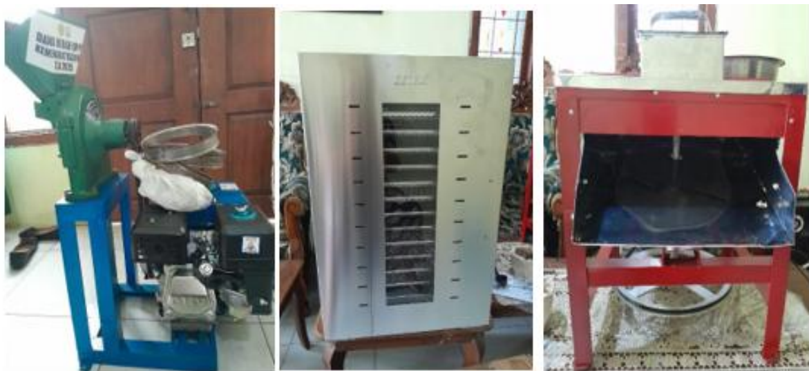
Gambar 2. Teknologi yang digunakan dalam pembuatan tepung pisang (mesin perajang, mesin pengering, dan mesin penepung)
