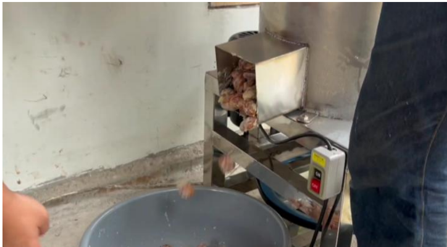
Gambar 4. Biji yang sudah bersih dari mesin ekstraktor durian
