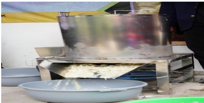
Gambar 8. Tampak Fisik Mesin Ekstraktor Durian (Pemisah Daging Dan Biji Durian)
