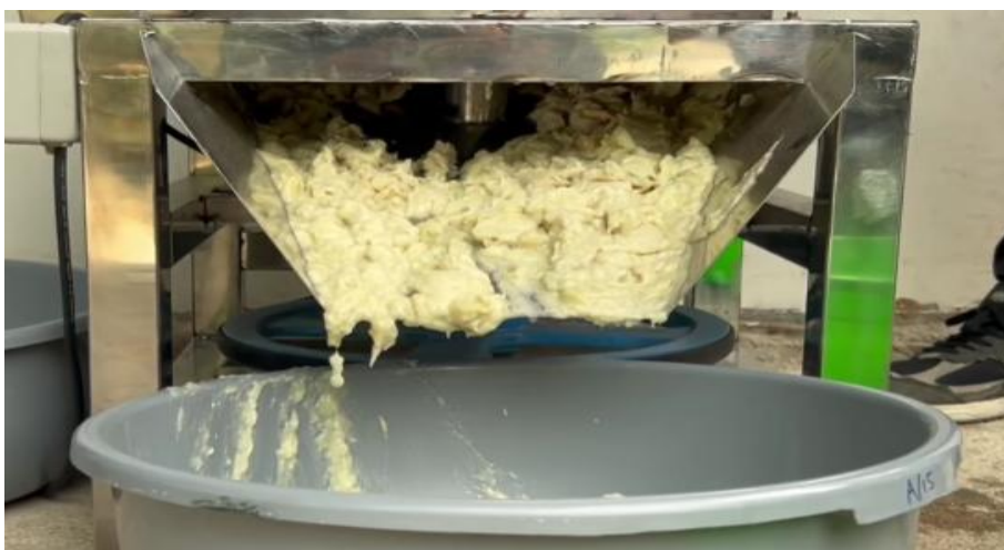
Gambar 3. Proses pemisahan daging buah durian oleh mesin ekstraktor durian
