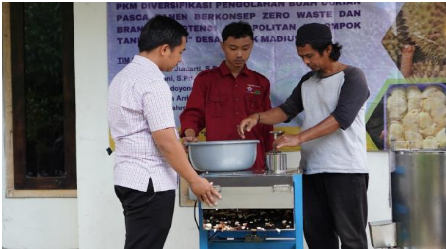
Gambar 6. Penerapan Mesin Perajang Biji Durian Model Horizontal Pada Kelompok Tani “Lestari”
