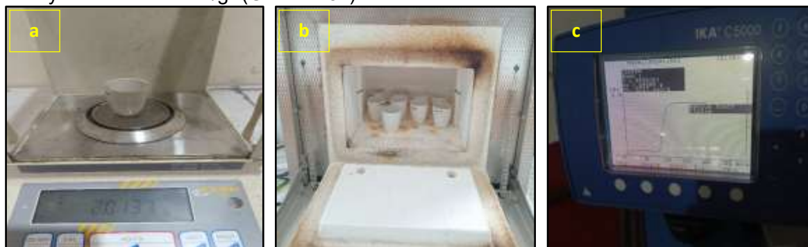
Gambar 3. a) Penimbangan sampel; b) Pengujian abu; c) Pengujian kalor (Sumber: dokumentasi peneliti)
