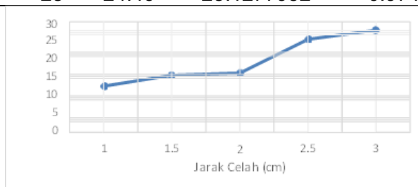
Gambar 8. Grafik tegangan standar terhadap jarak celah pada busbar tembaga 0.5cm dengan posisi 1
