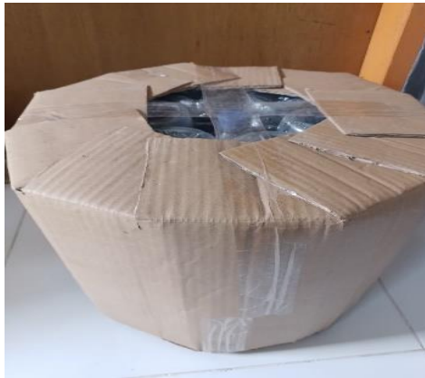
Gambar 3. Pembungkusan dengan kardus: Botol yang telah direkatkan dibungkus dengan kardus sesuai bentuk kursi.
