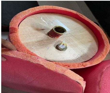
Gambar 5. Pemasangan spon dan kain: Spon digunakan untuk kenyamanan, sedangkan kain bekas membungkus kursi untuk estetika.
