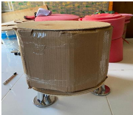
Gambar 4. Pemasangan triplek: Triplek dipasang di bagian atas dan bawah kerangka sebagai penopang.
