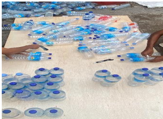
Gambar 2. Perekatan botol plastik: Siswa merekatkan botol plastik hingga membentuk kerangka kursi berdiameter 30 cm.
