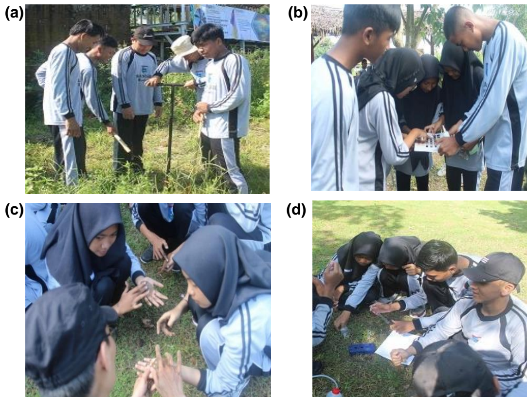
Gambar 4. (a) Pengambilan sampel tanah menggunakan bor tanah; (b) Identifikasi warna tanah; (c) identifikasi tekstur tanah dan (d) Identifikasi tingkat kimiawi/pH tanah
