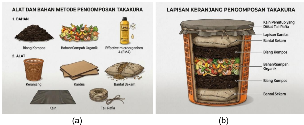
Gambar 4. (a) Alat dan bahan metode pengomposan Takakura (b) Lapisan keranjang pengomposan Takakura.
