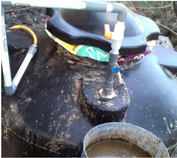
Gambar 6. Biodigester yang sudah terisi menunggu proses pembentukan gas
