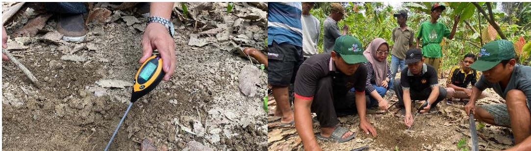
Gambar 4. Pelatihan penggunaan soil analyzer dan soil moisture meter
