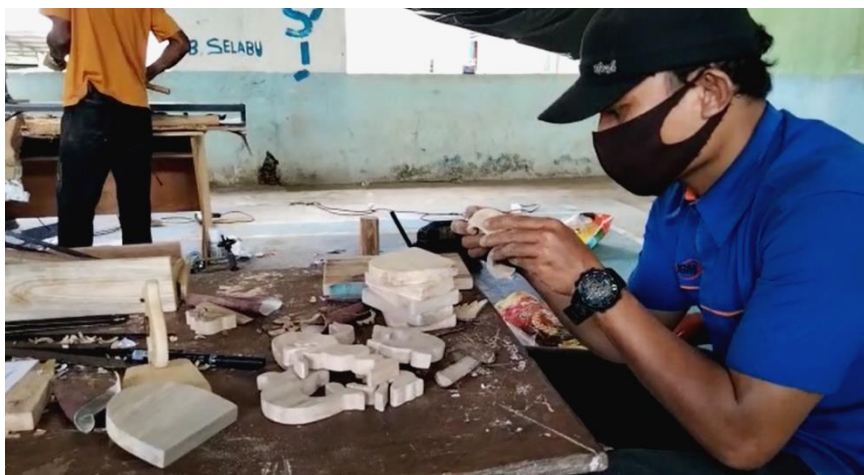
Gambar 13. Proses penghalusan permukaan kayu (Foto : Husni, 2022)
