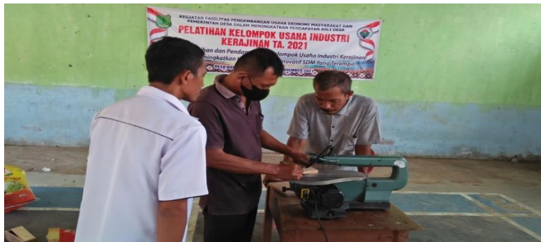
Gambar 10. Kegiatan pelatihan menggunakan mesin scrollsaw untuk memproduksi souvenir gantungan kunci dan stand handphone. (Foto : Mukhsin, 2022)
