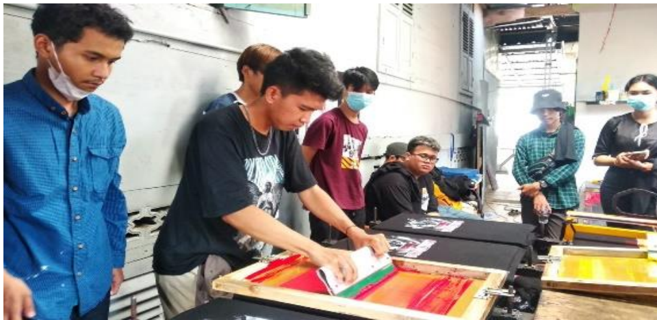
Gambar 8. Proses sablon dari tahap persiapan sampai pada tahap cetak
