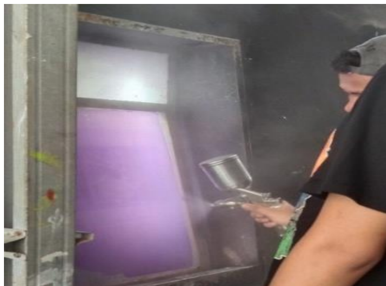
Gambar 7. Proses penyemprotan film sablon sablon yang telah diafdruk
