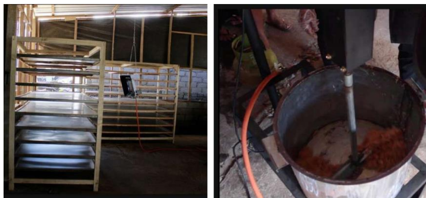
Gambar 2. Oven pengering serta mesin pemasak dan pengaduk serundeng yang diterapkan pada mitra
